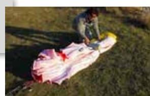
**Schritt 5** Lege die Schaumstoffrolle hinter die Anströmkante – auf die erste Faltung. Das verringert den Winkel der Faltung und schützt die Plastikverstärkungen. Danach faltest du die Hinterkante vorsichtig und nicht zu eng um die Anströmkante.
