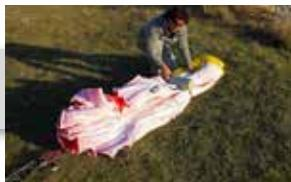
**Etape 5** Placez le coussin pliant derrière le bord d'attaque. Ceci diminue l'angle des plis et aide à la conservation des renforts. Repliez ensuite le bord de fuite autour du bord d'attaque en évitant autant que possible un pliage trop serré.
