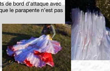
**Etape 3** Grouvez les nervures du milieu d'aile, en rassemblant les pattes B et C.
